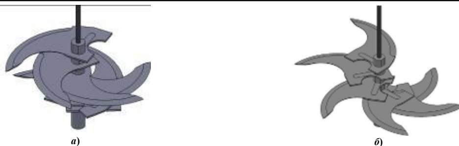
Рисунок 4. Підвіска для комплексу кутерних ножів в двох варіантах складання: а- закритий; б- розкритий
