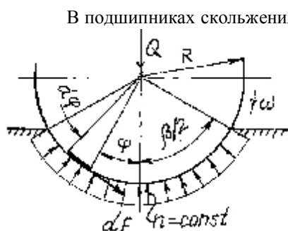
Рис. 1 – Принятая в [1] расчётная схема распределения давления
