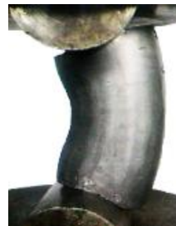
Рис. 3 – Схема обмера и образцы после эксцентричной осадки выпуклыми бойками с радиусом R : а - б – H_0/D_0 = 1,0 ; в - г – H_0/D_0 = 2,0 ; H_1, H_2, d, D_3, D'_3, D_{4-1}, D_{4-2}, D'_{4-1}, D'_{4-2} – контролируемые размеры
