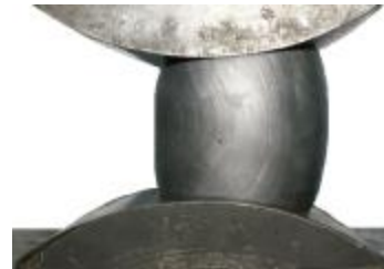
Рис. 2 – Схема эксцентричной осадки заготовки радиусными бойками: 1 - 2 – верхняя и нижняя осадочная плита; 3 - 4 – верхний и нижний радиусный боек; 5 – заготовка
