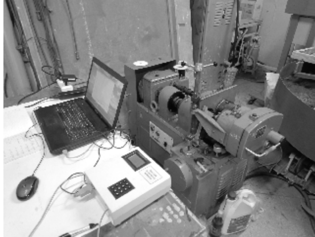
Рис. 1 – Машина тертя СМЦ-2 модернізована електронним блоком для визначення моменту тертя
