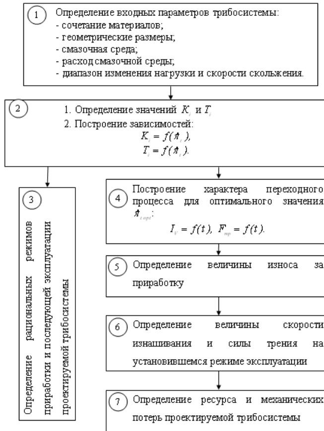
Рис. 1 – Структура методики математического моделирования переходных процессов
