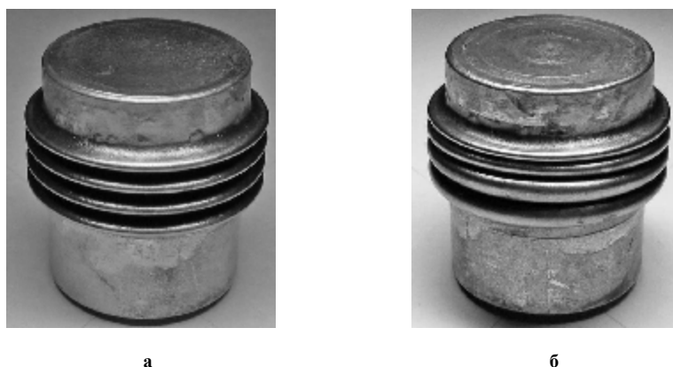
Рис. 5 – Фотография образца сильфона до (а) и после (б) удара
