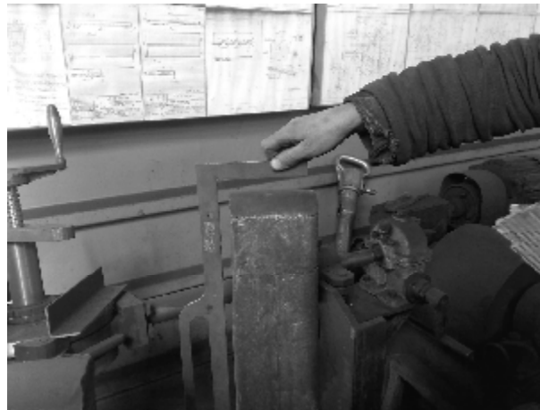
Рис. 2 – Визначення зносу шаблоном корпусу автозчепу електровозу ЧС 2
