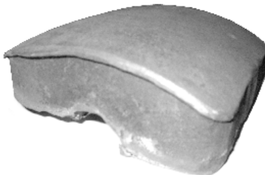
Рис. 10 – Залишки розклепу ударної поверхні хвостовика корпусу автотягачу
