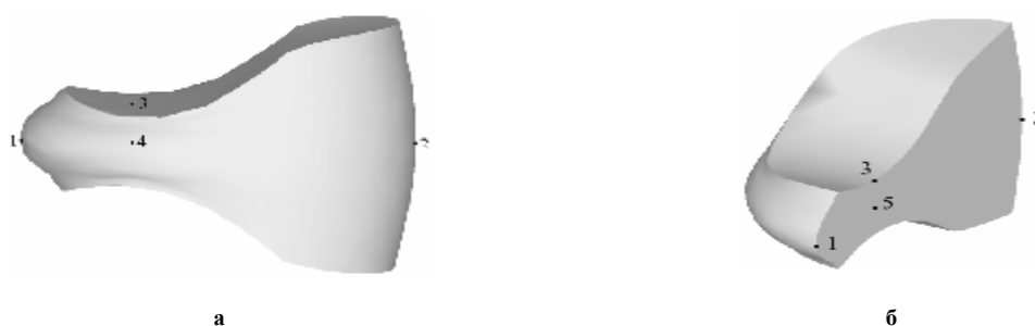
Рис. 2 – Твердотельная модель осажённой заготовки (а) и её половина по продольному разрезу (б) с обозначенными точками-маркерами для исследования изменений НДС
