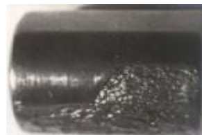
Рис. 8 – Втомне відлущування циліндричної поверхні ролика
