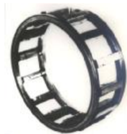
Рис. 7 – Знос кілець сепаратора
