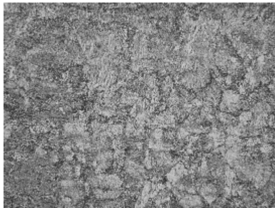
Рис. 3 – Микроструктура основного металла (сталь 65Г), увеличение \times 500
