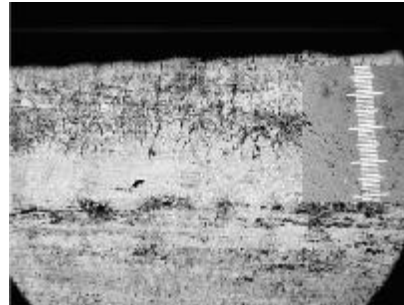
Рис. 3 – Мікротріщини в мартенситному шарі (1 под. – 10 мкм)
