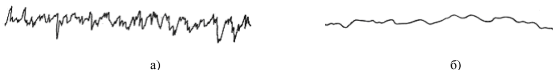
Рис.3 – Профилограммы поверхности трения аморфно-кристаллических покрытий в условиях граничной смазки маслом МС-20 (P=15 ПМа): а – R_a=0,34 мкм ( V=0,8 м/с); б – R_a=0,16 мкм ( V=1,5 м/с); (ВУх1000, ГУх40).
