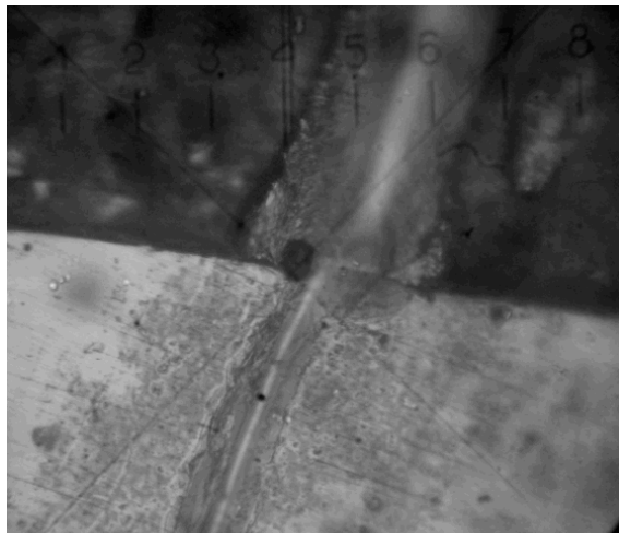
Рис. 1 – Покриття Ni + BN з треком для визначення міцності зчеплення з основою (x 462)
