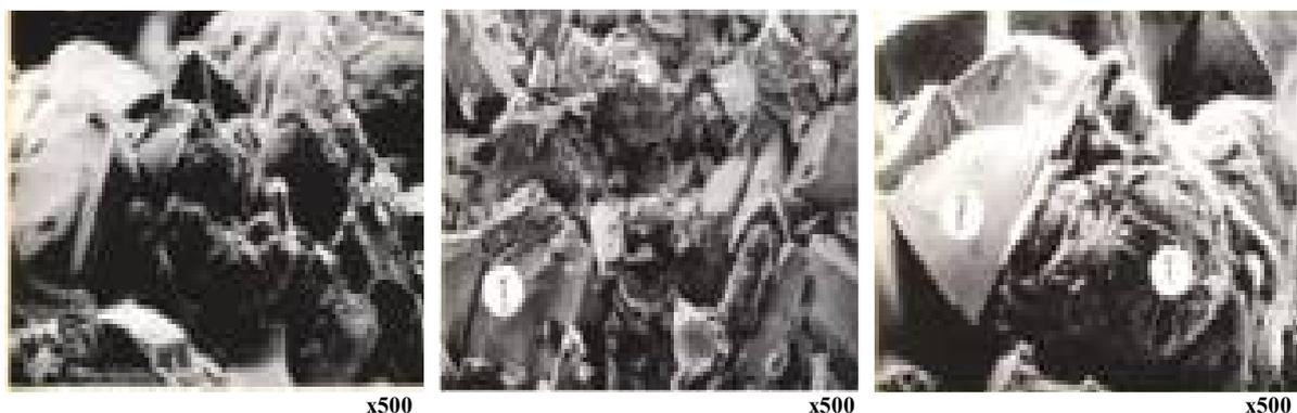
Рис. 3 – Фрактограмма покрытия, полученного ЭКПП шихты из 60 % ПГ-С1 и 40 % ФХ – 800; 1 – участок разрушения частиц ФХ - 800
