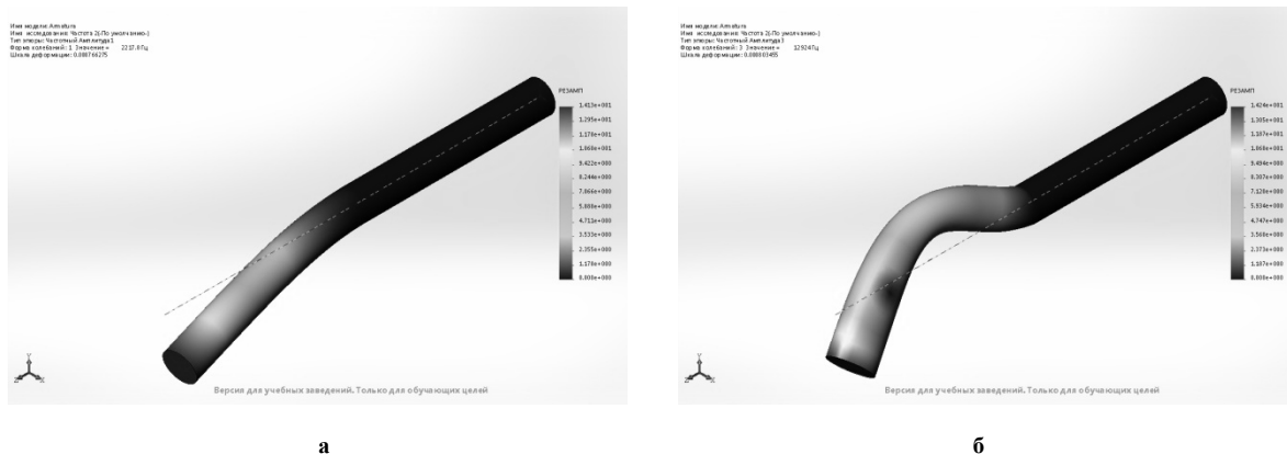
Рис. 6 – Форми коливань опори теплопроводу а – перша форма коливання; б – друга форма коливань
