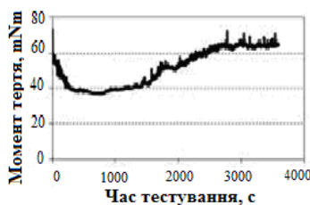
Рис. 7 – Характер зміни моменту тертя кульок в середовищі яловичого жиру
