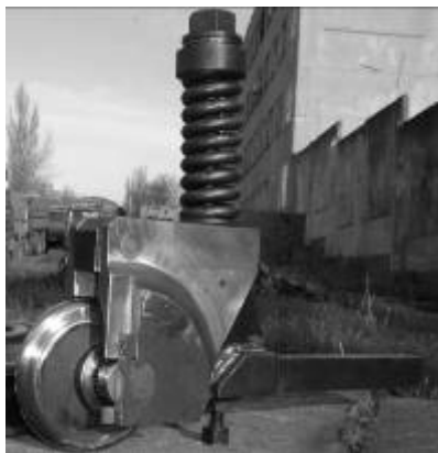
Рис. 9 – Экспериментальное устройство для обкатывания канатных блоков клиновым роликом
