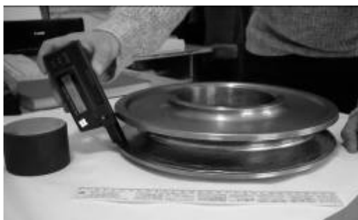
Рис. 11 – Измерение твердости профиля канатного блока после обкатывания для определения степени наклепа
