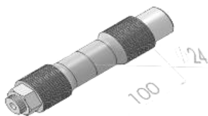
Рис. 2 – Схема зразків для визначення когезивної міцності покриттів
