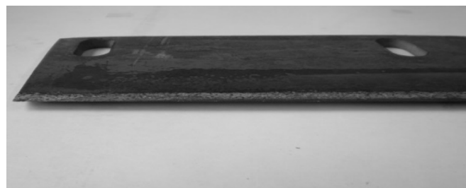
Рис. 2 – Нож з покриттям суцільної структури
