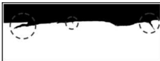
Рис. 11 – Развитие необратимых повреждений проката-проволоки при наличии закаленного слоя на поверхности металла (микротрещины выделены пунктирными линиями)
