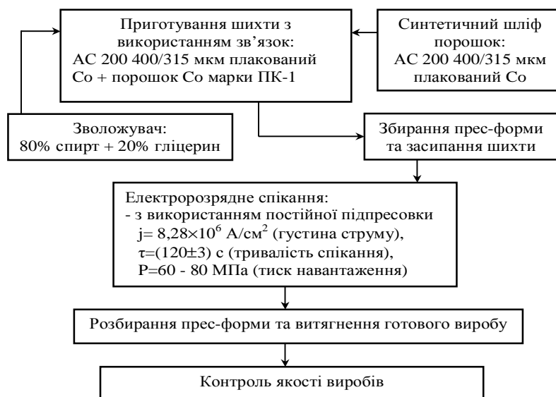
Рис. 6 – Схема отримання зразків із використанням ЕРС
