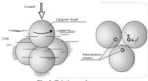
Fig. 3. Friction node
